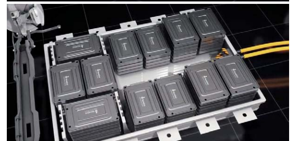
Bild 15: Die Flashbattery von StoreDot basiert auf organischen Halbleitern, kombiniert mit Nanomaterialien. Darunter der erste Fahrzeugakku, der laut StoreDot in fünf Minuten vollgeladen werden kann. Bild: StoreDot
