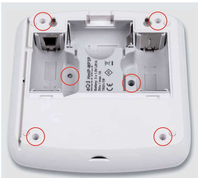
Bild 18: Die Gehäuseteile werden mit insgesamt sechs Schrauben verbunden.
