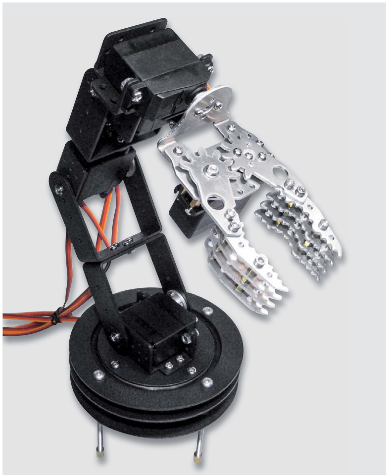
Bild 10: Über sechs Servos gesteuerter Roboterarm
