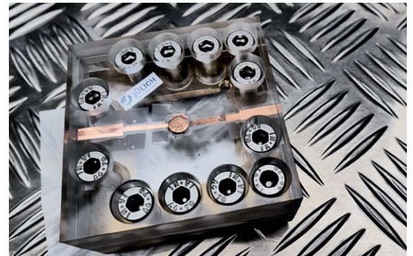
Bild 14: Testaufbau für die Festkörperbatterie: Die Batterie von der Größe einer Knopfzelle befindet sich in der Mitte des Plexiglasgehäuses, welches die dauerhafte Kontaktierung der Batterie sicherstellt. Das patentierte Konzept beruht auf einer günstigen Kombination von Materialien.
