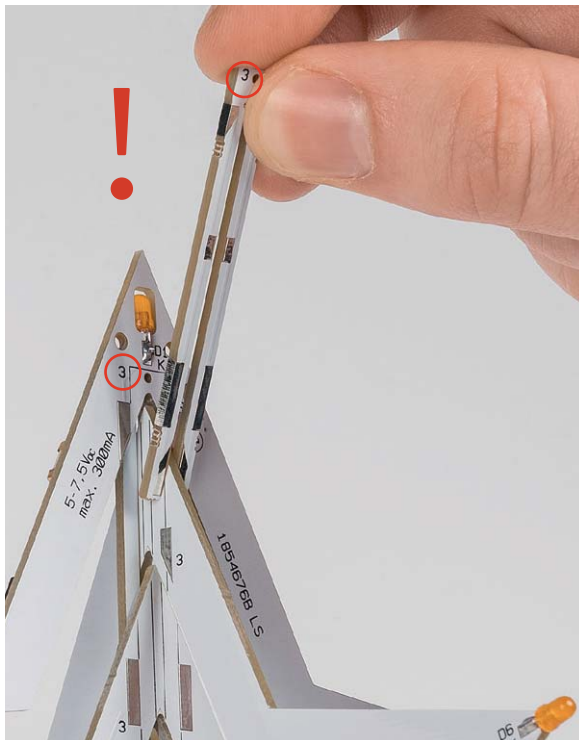
Bild 13: Hier ist das Einsetzen der Platine Nr. 3 zu sehen.
