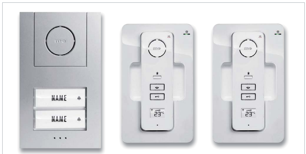
Bild 13: Eine Türsprechanlage mit DECT wie die hier gezeigte Funk-Türsprechanlage me AC-220 verfügt über die ausgereifte und weitreichende DECT-Funktechnologie. Die Innenstationen sind mobil, so kann man sie überall hin mitnehmen. Bild: me GmbH
