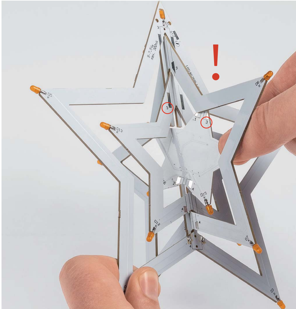
Bild 11: Die mittlere Sternplatine wird eingesetzt.
