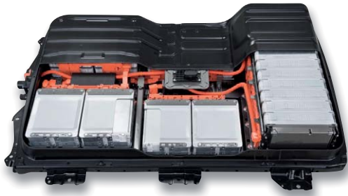
Bild 11: Typischer heutiger Lithium-Fahrzeug-Akku in einem Nissan Leaf. Bild: Nissan
