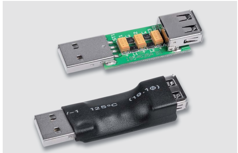
Bild 4: Das USB-EF1 vor und nach dem Einschrumpfen
