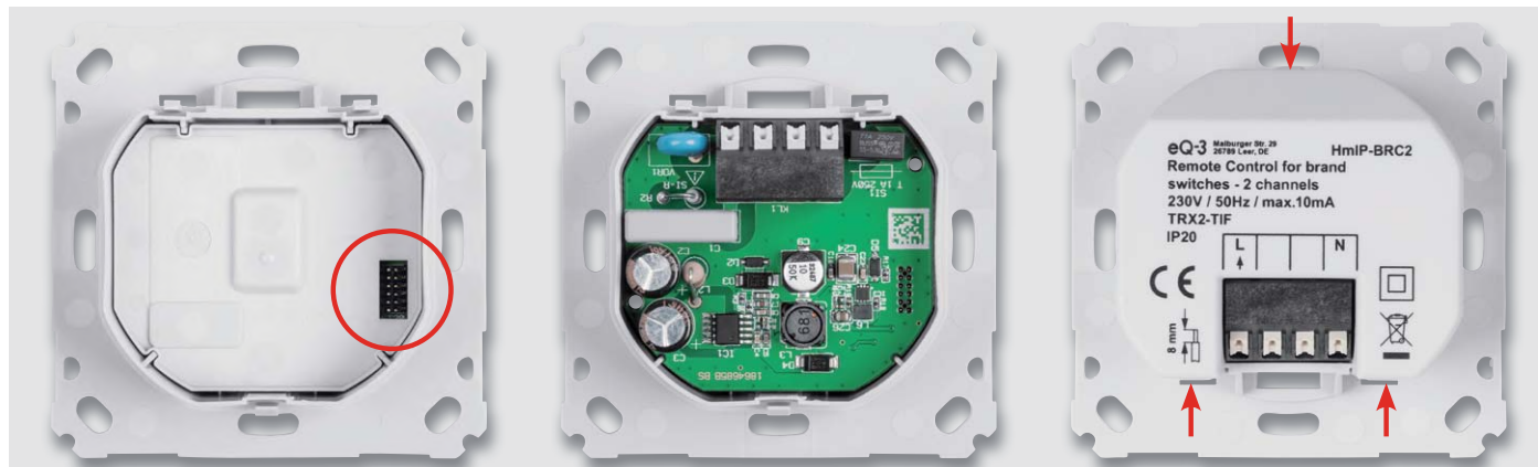
Bild 10: Die Isolierplatte zwischen Controller- und Stromversorgungsplatine ist eingelegt. Rechts unten ist die Steckerleiste für die Verbindung beider Platinen zu sehen.
