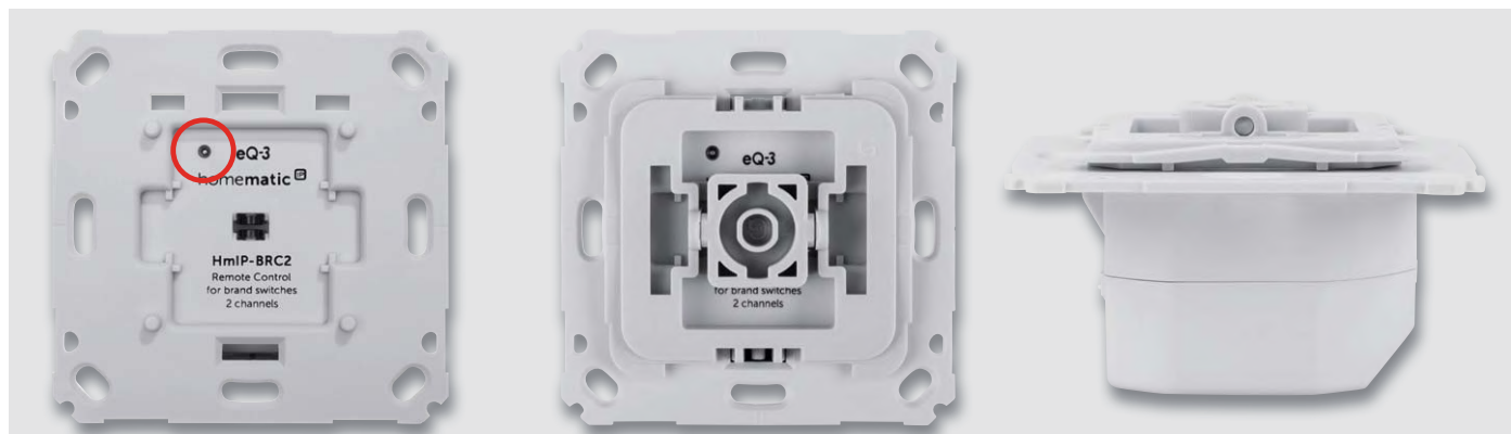
Bild 13: Der Tasterstößel ist auf Leichtigkeit zu prüfen.
