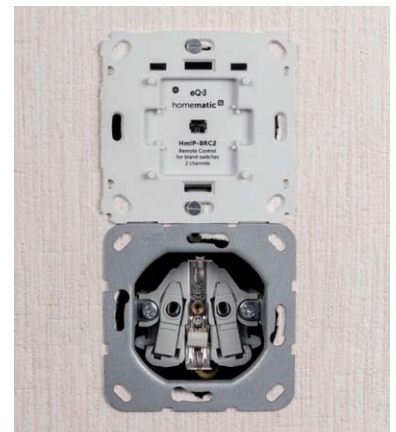
Bild 16: ... wird in die Installationsdose eingesetzt und verschraubt.
