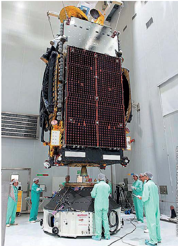
Bild 2: Der S-Band EAN/Hellas Sat 3 kurz vor der Fertigstellung. Deutlich sind die zusammengefalteten Solarpanels zu erkennen, die im Betrieb mit 37 m Spannweite knapp 13 kW elektrische Leistung erzeugen.
