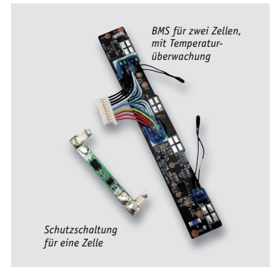
Bild 5: Lithium-Akkus sind fast immer ab Werk mit Batteriemanager- oder wenigstens Schutzsystemen gegen Tiefentladung und Überladung versehen.
