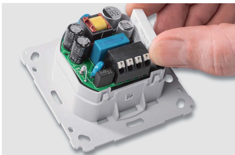
Bild 22: So wird die Netzteilplatine eingesetzt. Die Markierungen zeigen zwei der drei Rasten für das folgende Verrasten des Gehäuseunterteils. Die dritte Raste befindet sich auf der gegenüberliegenden Seite.
