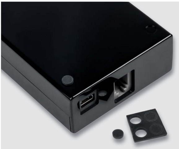
Bild 29: Ankleben der 4 Gehäusefüße an der Gehäuseunterseite
