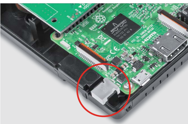
Bild 10: Eingesetzter Lichtleiter für die Act./Power-LEDs des Raspberry Pi
