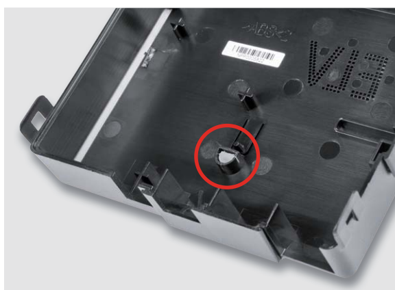
Bild 11: So wird der Lichtleiter der System-LED eingesetzt.
