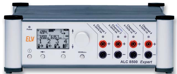
Bild 10: Spitzengerät für das Laden unterschiedlicher Akkutypen – mit dem ALC 8500-2 Expert ist auch eine genaue Anpassung an jeden zu ladenden Akku möglich.
