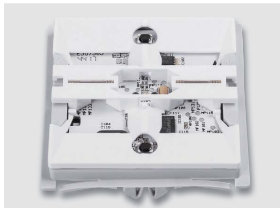
Bild 14: Der Lichtleiter muss plan auf der Controllerplatine und dem Gehäuseteil aufliegen.
