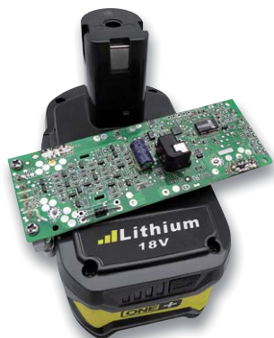
Bild 6: Aufwendiges BMS für einen 18-V-Werkzeugakku
