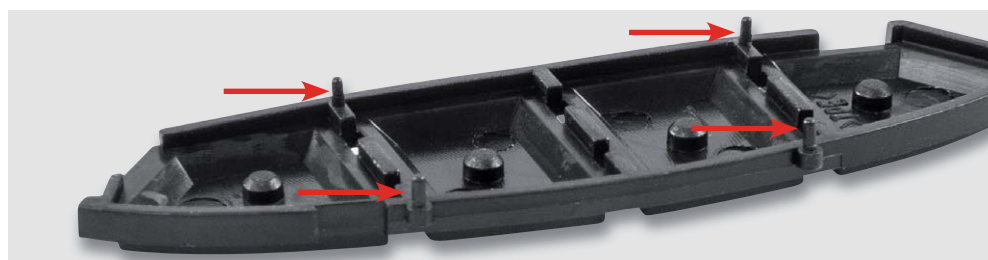
Bild 13: Hier sind die Führungsstifte der Tastaturmatte gut zu sehen.
